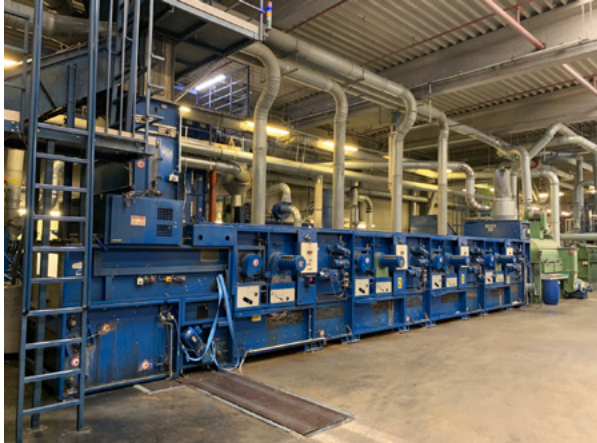
thrEADS-Forschende arbeiten mit einer Reißanlage zur Fasertrennung.
