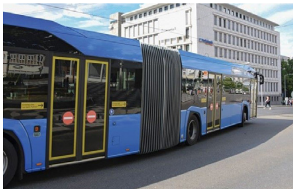
Faltenbälge müssen hohen Kräften und Witterungseinflüssen standhalten.
